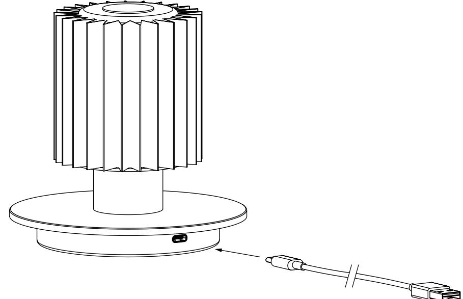
**Insérer la fiche USB-C dans le connecteur de l'appareil. La durée complète de chargement est de 3 heures. Lorsque l'appareil est allumé à 100% de l'intensité lumineuse, il peut fonctionner durant 7 heures sans câble.**
