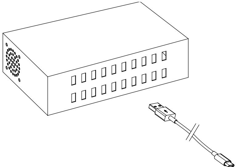
**Si vous utilisez le chargeur multiple, insérez la fiche USB-A sur un des ports USB. Après avoir branché le chargeur multiple sur le secteur, mettre sous tension en actionnant l'interrupteur à bascule situé sur le côté de l'appareil.**
